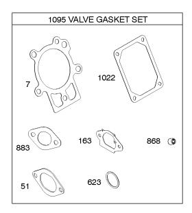
缸头,垫片组-发动机,垫片组-阀门
